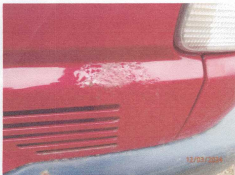
Wady nadwozia - korozja
