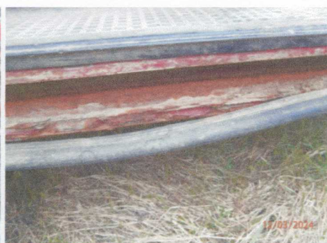
Wady nadwozia - korozja
