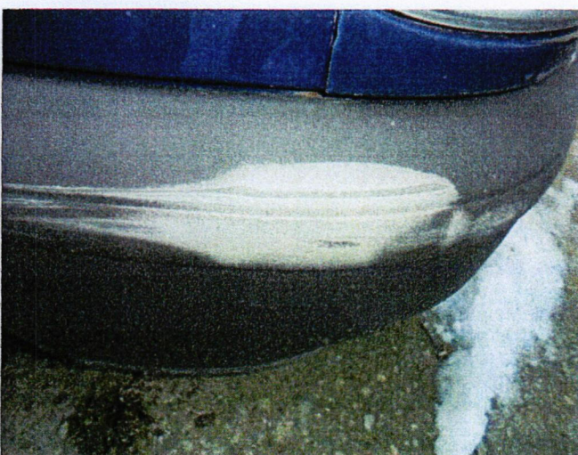
Uszkodzenia poszycia zderzaka
